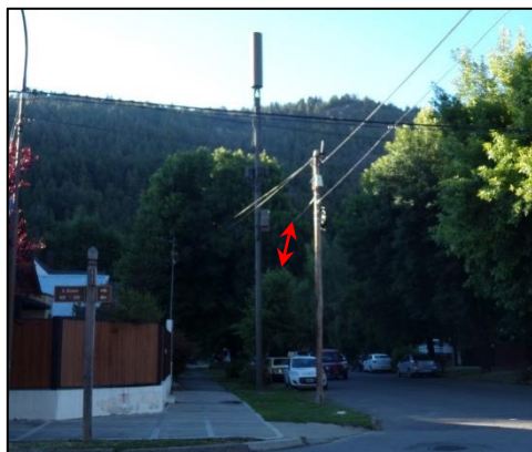
Figura 67: La flecha roja marca la distancia entre el ápice del árbol y el cable más próximo.
